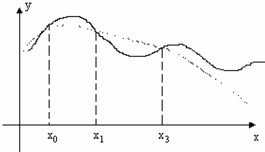
Conhecendo-se os valores de uma função  $f(x)$  em três pontos igualmente espaçados  $x_0 = a$ ,  $x_1$ ,  $x_2 = b$ , pode-se então aproximar a função por um polinômio do 2º grau e calcular o valor aproximado de sua integral no intervalo  $[a,b]$ , através da integral do polinômio interpolador.
